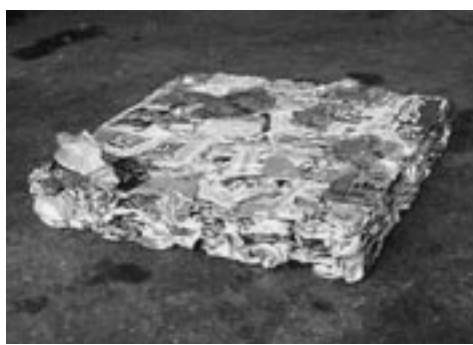
▲ブロック1つにスチールで約17kg、アルミで約7kg
