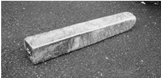
▲写真は溶解され固形状に加工されたトレー・発砲スチロールで1本約7kgです。1本作るのに約1,200～1,300枚の食品トレーが用いられています。
